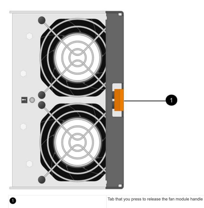
5. Use the fan module handle to pull the fan module out of the shelf.
