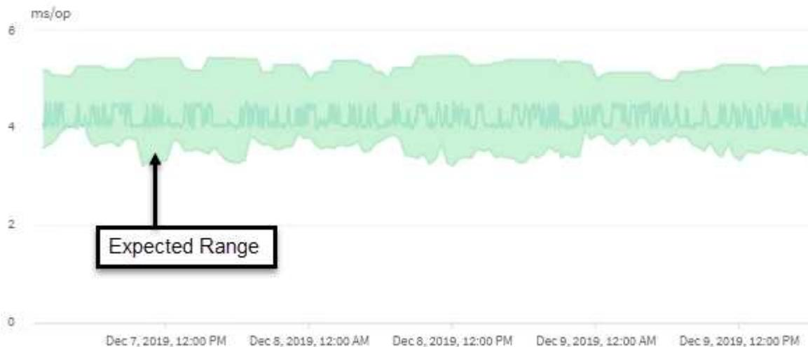
In diesem Beispiel weist die Latenz für ein Volume graue Latenzprognosen von 3.5 Millisekunden pro Betrieb (ms/op) mit dem niedrigsten Wert und 5.5 ms/op bei dem höchsten Wert auf. Wird die tatsächliche Latenz blau auf plötzlich 10 ms/op erhöht, weil der Netzwerk-Traffic oder die Konflikte einer Cluster-Komponente zeitweise zu hoch sind, liegt sie über der Latenzprognose und hat den dynamischen Performance-Schwellenwert überschritten.
