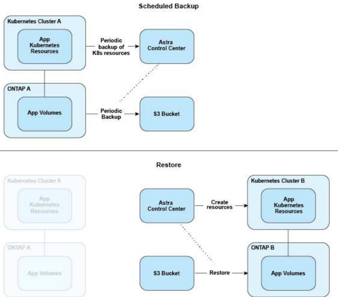
Andererseits wird die Replizierung zu ONTAP durchgeführt. Durch ein Failover werden die Kubernetes-Ressourcen erzeugt:
