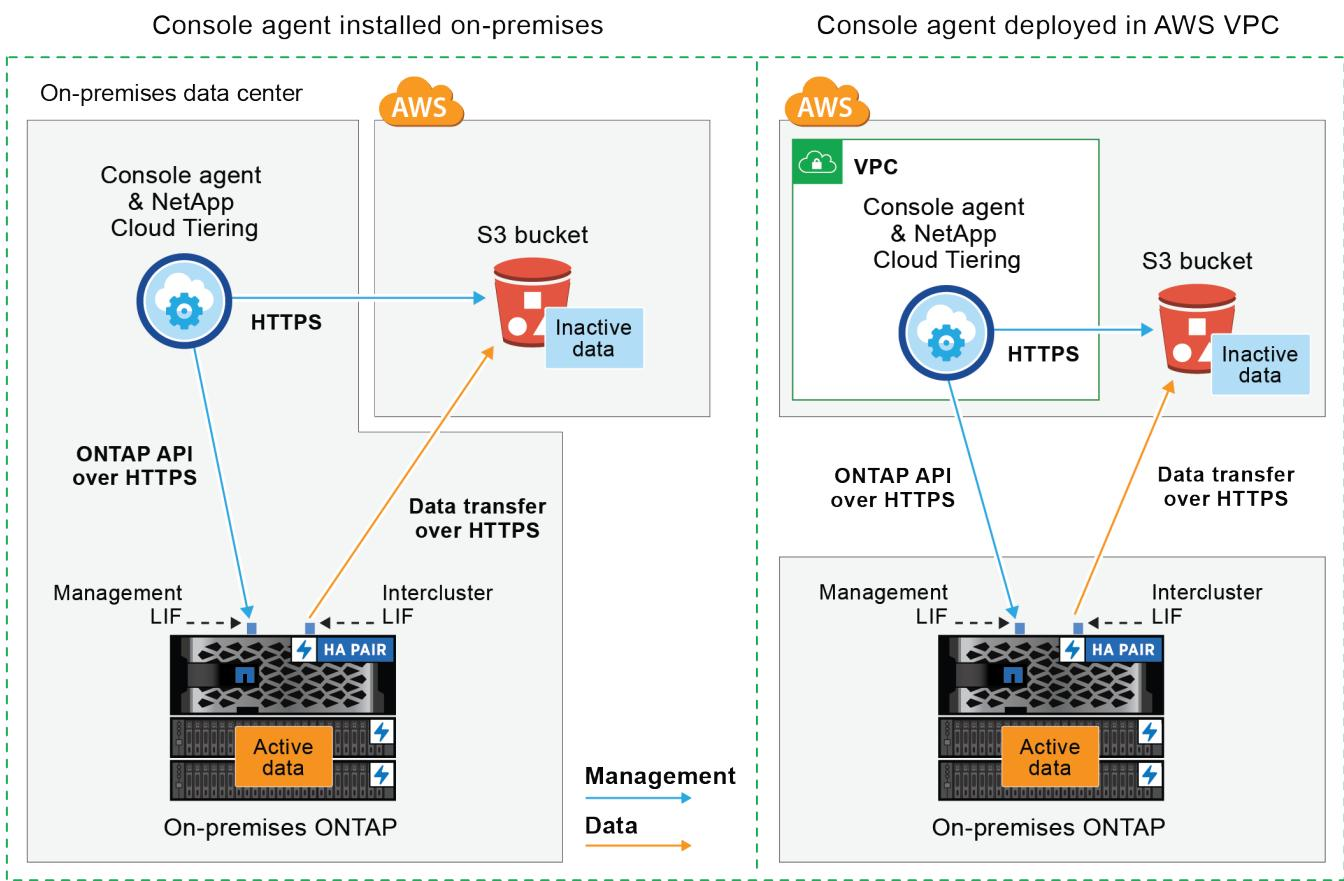
Das folgende Diagramm zeigt die Methode **private Verbindung** und die Verbindungen, die Sie zwischen den Komponenten vorbereiten müssen. Sie können den Konsolenagenten verwenden, den Sie vor Ort installiert haben, oder einen Agenten, den Sie im AWS VPC bereitgestellt haben.
