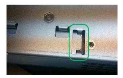
Incorrect — der Metallflansch der Batterie ist nicht in den Steckplatz am Controller eingelegt:
