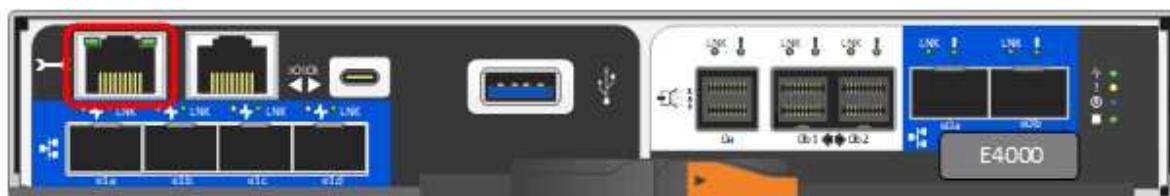
2. Öffnen Sie einen Browser, und verwenden Sie die Standard-IP-Adresse (169.254.128.101), um eine Verbindung zum Controller herzustellen. Der Controller sendet ein selbstsigniertes Zertifikat zurück. Der Browser informiert Sie darüber, dass die Verbindung nicht sicher ist.
