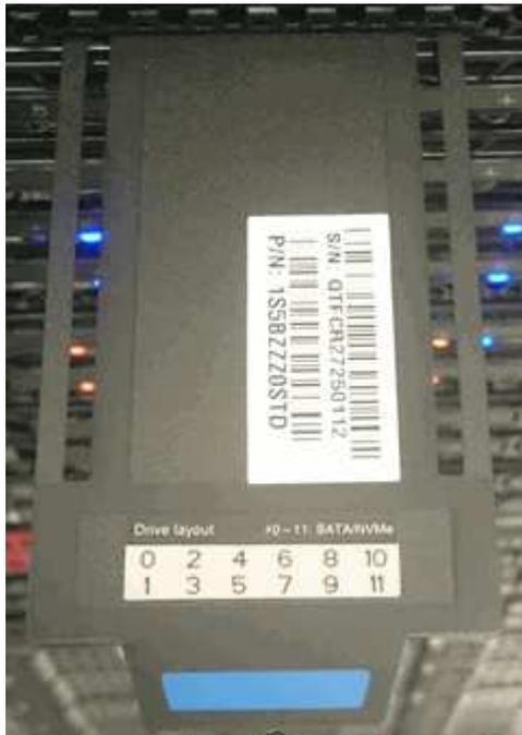
2. Vergewissern Sie sich, dass die Seriennummer auf der Service-Tag-Nummer der NetApp Support-Fallnummer bei der Bestellung des Ersatzgehäuses entspricht.
