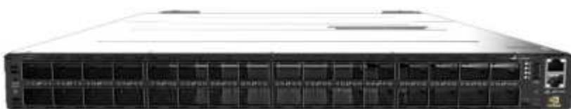
NVIDIA Quantum-2 QM9700-Switches mit 400 Gb/s InfiniBand-Konnektivität versorgen das Compute Fabric in NVIDIA Quantum-2 InfiniBand BasePOD-Konfigurationen mit Strom. Für das InfiniBand-Compute-Fabric werden ConnectX-7-Einzelportadapter verwendet. Jedes NVIDIA DGX-System verfügt über zwei Verbindungen zu jedem QM9700-Switch und bietet so mehrere Pfade mit hoher Bandbreite und geringer Latenz zwischen den Systemen.
