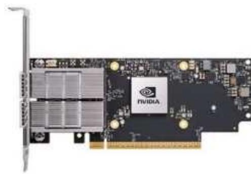
Der NVIDIA ConnectX-7-Adapter kann einen Durchsatz von 25/50/100/200/400 G bereitstellen. NVIDIA DGX-Systeme verwenden sowohl die ConnectX-7-Adapter mit einem als auch mit zwei Anschlüssen, um Flexibilität bei DGX BasePOD-Bereitstellungen mit 400 Gb/s InfiniBand und Ethernet zu bieten.
