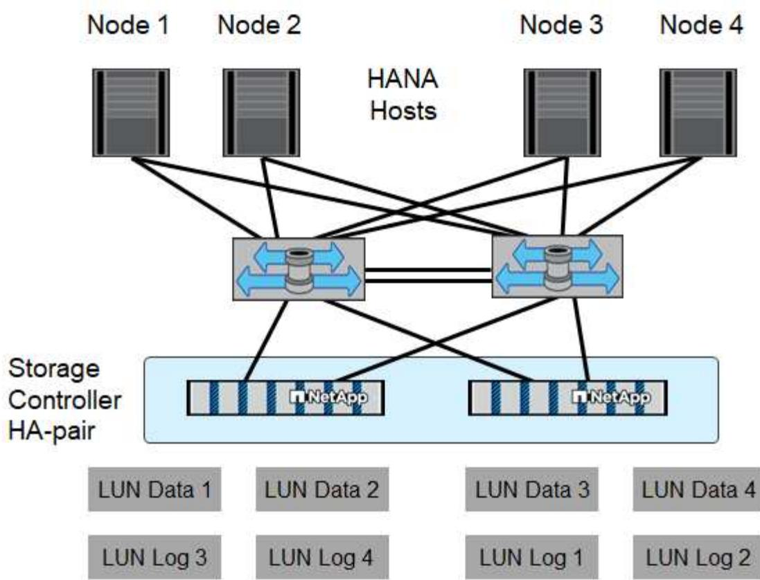
Zusätzlich zum Zoning auf der Switch-Ebene müssen Sie jede LUN auf dem Storage-System den Hosts zuordnen, die mit dieser LUN verbunden sind. Einfachheit beim Zoning auf dem Switch; das heißt, Festlegung eines Zoneneinteils, in dem alle Host-HBAs alle Controller-HBAs sehen können.
