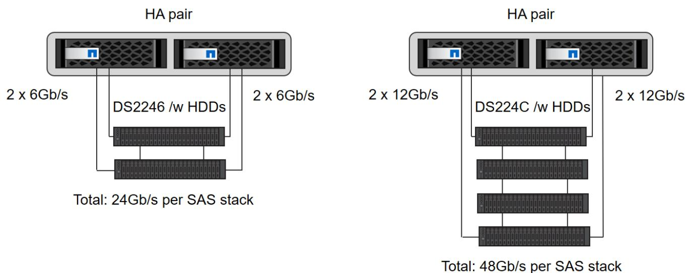
Bei SSDs kann maximal ein Platten-Shelf mit einem SAS-Stack verbunden werden, um die erforderliche Performance für die SAP HANA-Hosts zu liefern, wie in der folgenden Abbildung dargestellt. Die Festplatten in jedem Shelf müssen gleichmäßig auf beide Controller des HA-Paars verteilt werden. Mit dem DS224C Festplatten-Shelf können auch Quad-Path-SAS-Verkabelung verwendet werden, ist aber nicht erforderlich.
