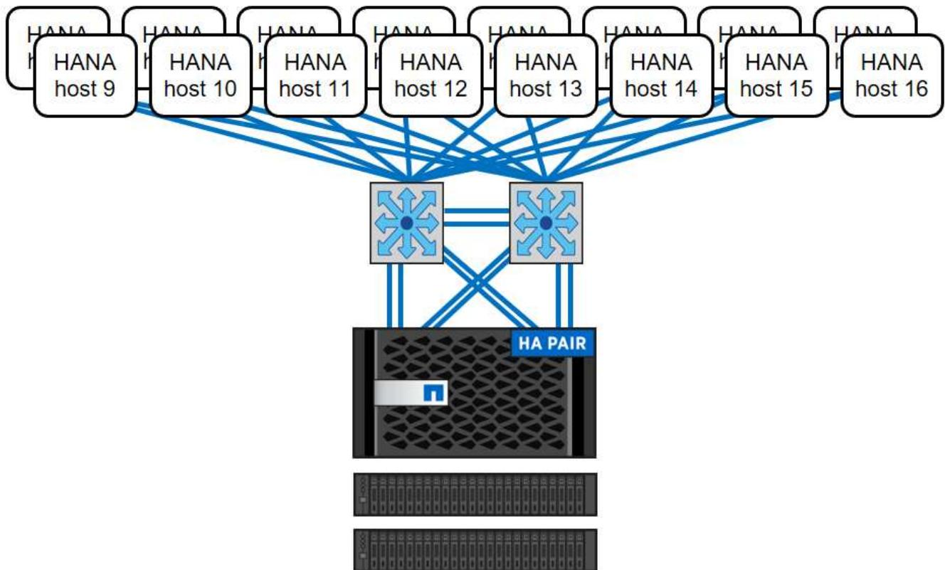
Unabhängig vom implementierten FAS System lässt sich die SAP HANA Landschaft auch skalieren, indem beliebige der zertifizierten Storage-Controller hinzugefügt werden, um die gewünschte Node-Dichte zu erfüllen (siehe folgende Abbildung).
