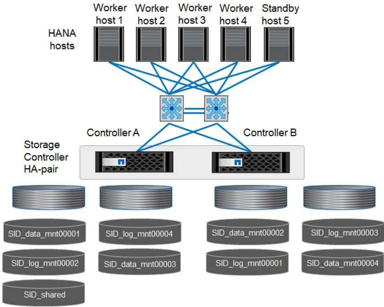
Für jeden SAP HANA-Host werden ein Daten-Volume und ein Protokoll-Volume erstellt. Der /hana/shared Volume wird von allen Hosts des SAP HANA-Systems verwendet. Die folgende Tabelle zeigt eine Beispielkonfiguration für ein SAP HANA-System mit mehreren Hosts und vier aktiven Hosts.
