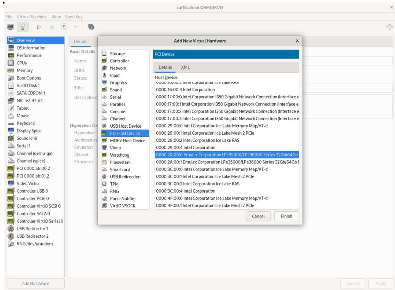
5. Wählen Sie den gewünschten HBA-Port aus der Liste der PCI-Hostgeräte des zweiten Fabric aus und drücken Sie auf Fertigstellen. In diesem Beispiel 0000.A2:00:1.
