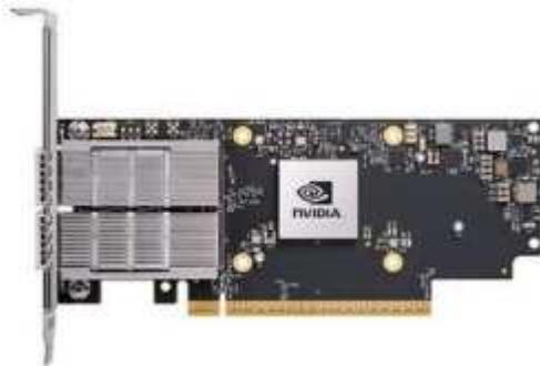
Der NVIDIA ConnectX-7-Adapter bietet einen Durchsatz von 25/50/100/200 G. NVIDIA DGX Systeme verwenden sowohl den Single- als auch den Dual-Port ConnectX-7-Adapter, um die Flexibilität von DGX BasePOD-Implementierungen mit 400 GB/s InfiniBand und Ethernet zu erhöhen.
