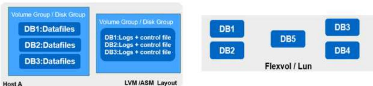
Um die Verschiebung von Oracle Datenbanken zu erleichtern, sollte Oracle-Binärdatei auf einer separaten LUN installiert werden, die in der regelmäßigen Backup-Richtlinie enthalten ist. So wird sichergestellt, dass bei der Datenbankverschiebung zu einem neuen Serverhost der Oracle Stack für eine Recovery ohne potenzielle Probleme aufgrund einer aus der Synchronisierung bestehenden Oracle-Binärdatei gestartet werden kann.
