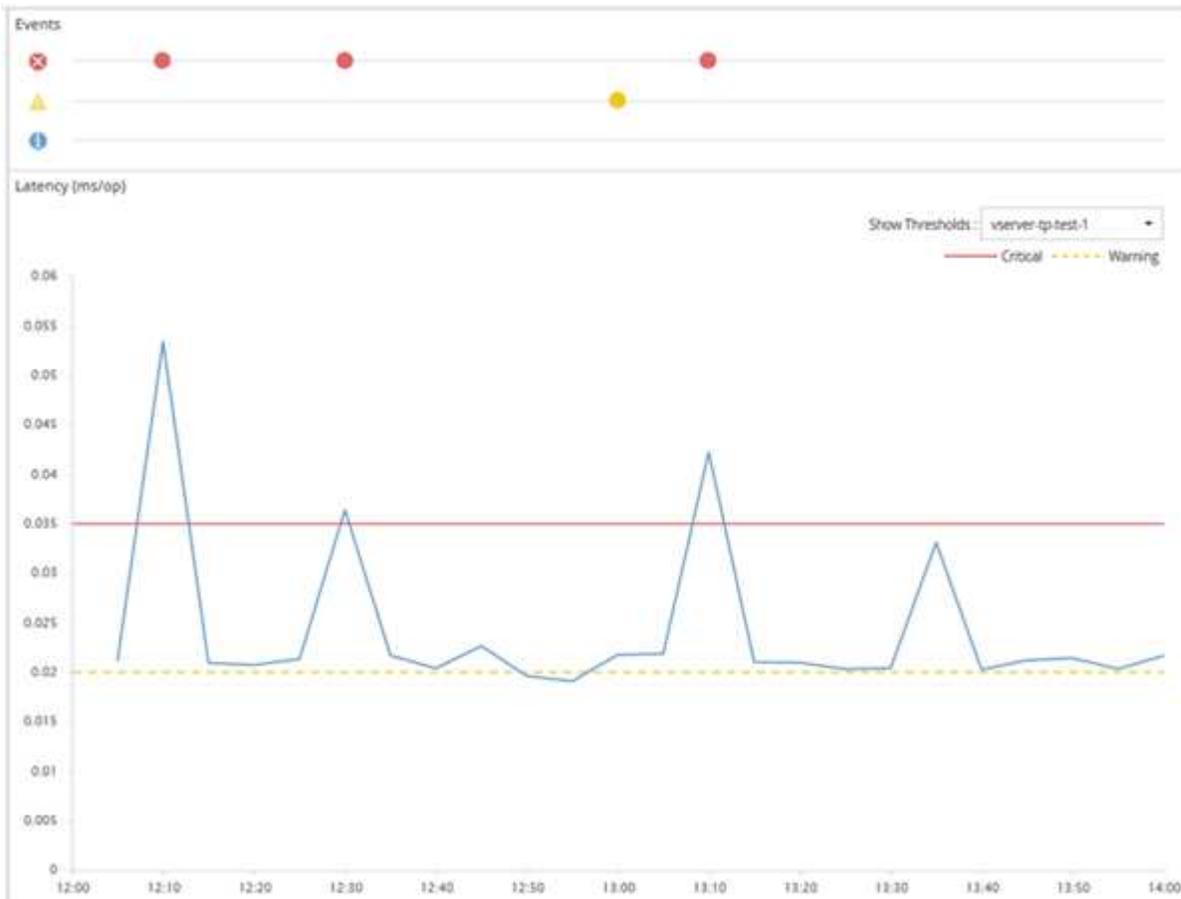
Für die angegebene Dauer muss eine Schwellenverletzung kontinuierlich auftreten. Wenn der Schwellenwert aus irgendeinem Grund unter die Grenzwerte fällt, wird eine spätere Verletzung als Beginn einer neuen Dauer betrachtet.
