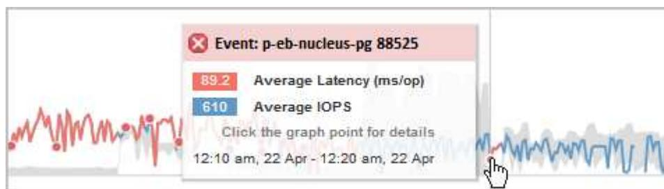
In diesem Beispiel wird ein Ereignis durch einen roten Punkt ( angezeigt) Auf der Latenzkarte auf der Seite Performance/Volume Details. Wenn Sie den Mauszeiger über den roten Punkt bewegen, wird ein Popup-Fenster mit weiteren Details zu dem Ereignis und Optionen zur Analyse angezeigt.
