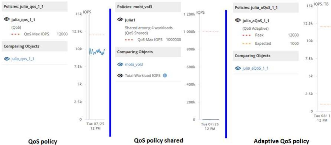
Wenn eine normale QoS-Richtlinie, die in IOPS definiert wurde, im IOPS/TB-Diagramm für einen Workload angezeigt wird, konvertiert ONTAP den IOPS-Wert in einen IOPS/TB-Wert, und Unified Manager zeigt diese Richtlinie im IOPS/TB-Diagramm zusammen mit dem Text „QoS“, definiert in IOPS“ an.
