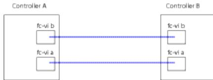
Die obige Abbildung ist eine typische Darstellung der erforderlichen Verkabelung. Die spezifischen FC-VI-Ports variieren je nach Controller-Modul.
