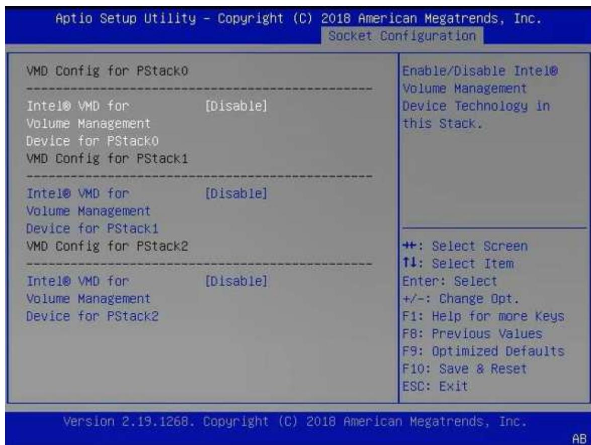
4. Konfigurieren Sie die NVMe-Laufwerke für die Weiterleitung an virtuelle Maschinen.
