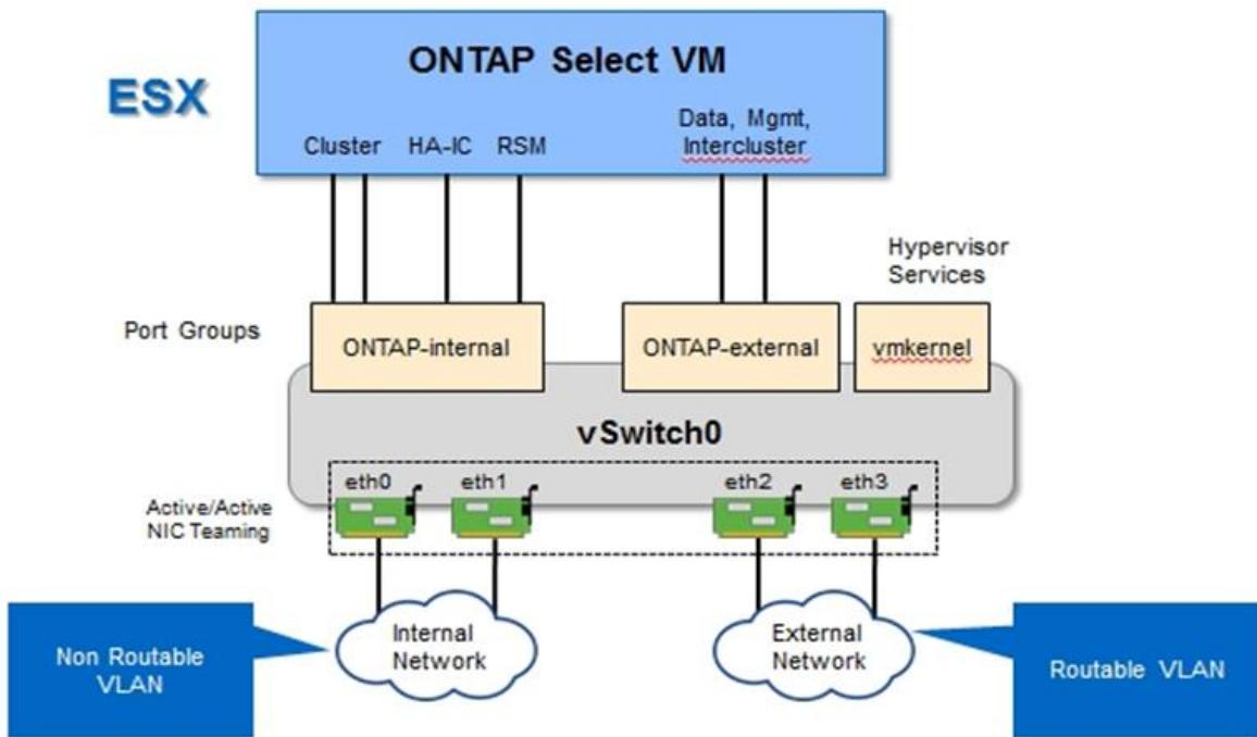
Die Trennung des internen und externen Datenverkehrs über verschiedene physische Netzwerkkarten verhindert Latenzen im System aufgrund unzureichenden Zugriffs auf Netzwerkressourcen. Darüber hinaus stellt die Aggregation durch NIC-Teaming sicher, dass der Ausfall eines einzelnen Netzwerkadapters den ONTAP Select Clusterknoten nicht am Zugriff auf das jeweilige Netzwerk hindert.
