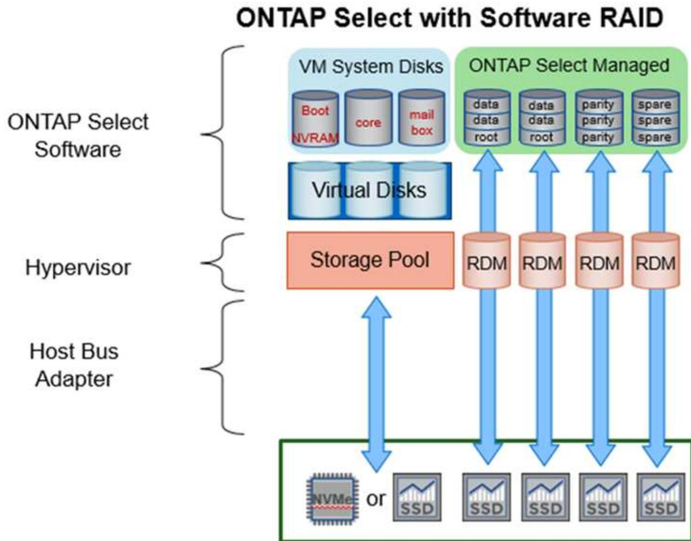
Die Systemfestplatten (VMDKs) befinden sich im selben Datenspeicher und auf derselben physischen Festplatte. Die virtuelle NVRAM Festplatte erfordert ein schnelles und langlebiges Medium. Daher werden nur NVMe- und SSD-Datenspeicher unterstützt.
