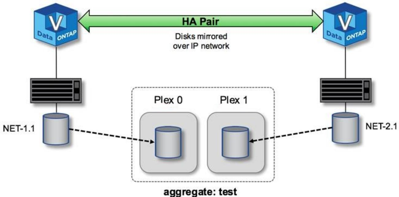
**i** Bei der Bereitstellung eines ONTAP Select Clusters werden alle im System vorhandenen virtuellen Festplatten automatisch dem richtigen Plex zugewiesen, ohne dass der Benutzer zusätzliche Schritte zur Festplattenzuweisung unternehmen muss. Dies verhindert die versehentliche Zuweisung von Festplatten zu einem falschen Plex und sorgt für eine optimale Konfiguration der gespiegelten Festplatten.
