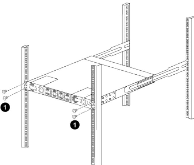
(1) Während eine Person die Vorderseite des Chassis waagerecht hält, sollte die andere Person die vier hinteren Schrauben an den Gehäusepfosten vollständig festziehen.
