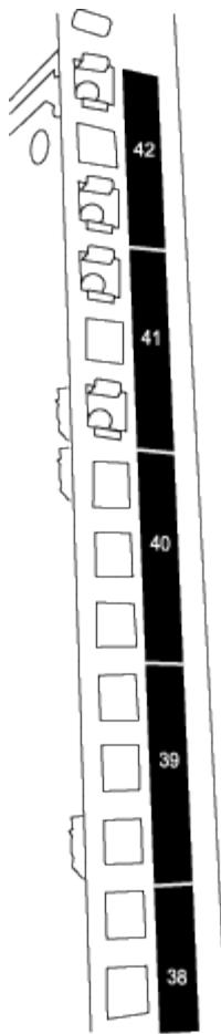
Die beiden 3232C-Switches werden immer in den oberen 2 HE des Schranks RU41 und 42 montiert.
