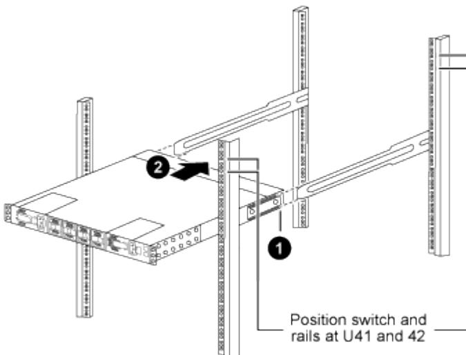
(1) Beim Hineinschieben des Chassis in Richtung der hinteren Pfosten müssen die beiden hinteren Rack-Montageführungen mit den Gleitschienen ausgerichtet werden.
