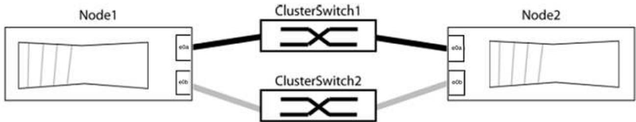
Überprüfen Sie, ob die Ports einen Wert von `up` für die Spalte „Link“ und einen Wert von `healthy` für die Spalte „Integritätsstatus“.
