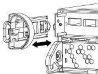
3. Drücken Sie die Verriegelung am Nockengriff, bis sie loslässt, öffnen Sie den Nockengriff vollständig, um das Controller-Modul aus der Mittelplatine zu lösen, und ziehen Sie das Controller-Modul anschließend mit zwei Händen aus dem Gehäuse heraus.
