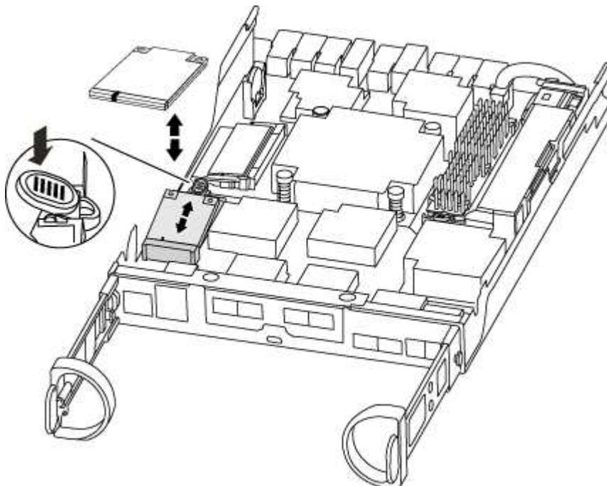
2. Drücken Sie die blaue Taste am Startmediengehäuse, um die Startmedien aus dem Gehäuse zu lösen, und ziehen Sie sie vorsichtig gerade aus der Buchse des Boot-Mediums heraus.
