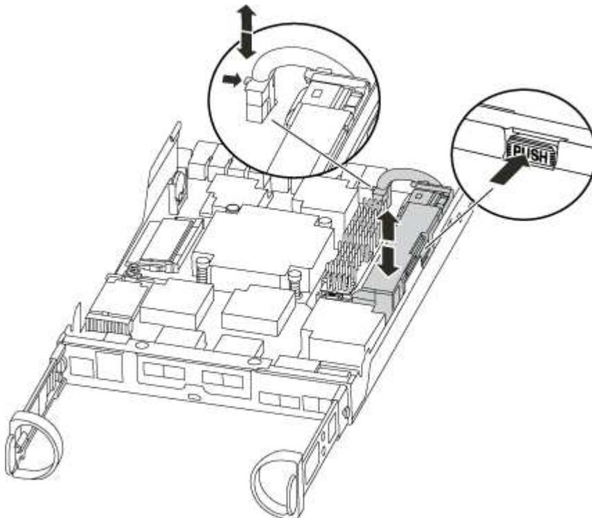
4. Suchen Sie den Batteriestecker, und drücken Sie den Clip auf der Vorderseite des Batteriesteckers, um den Stecker aus der Steckdose zu lösen, und ziehen Sie dann das Akkukabel aus der Steckdose.
