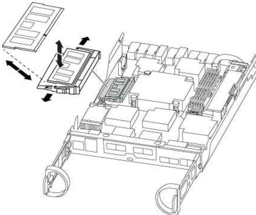
4. Wiederholen Sie diese Schritte, um bei Bedarf weitere DIMMs zu entfernen.
