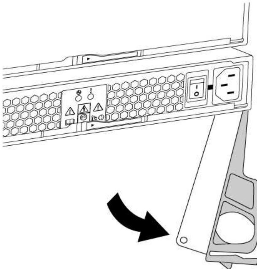
5. Schieben Sie die Stromversorgung mit dem Nockengriff aus dem System heraus.
