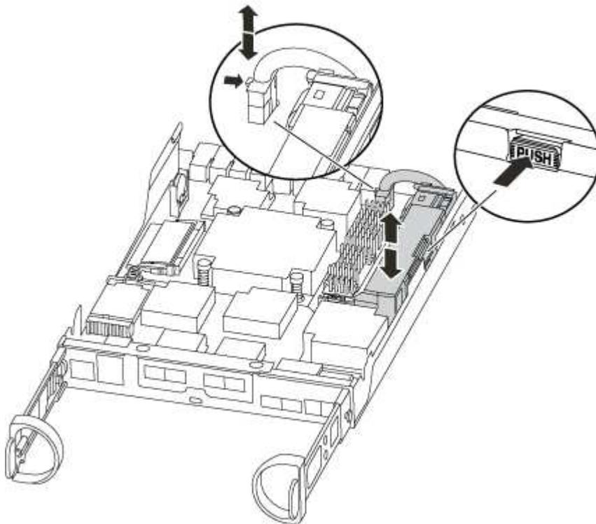
3. Suchen Sie den Batteriestecker, und drücken Sie den Clip auf der Vorderseite des Batteriesteckers, um den Stecker aus der Steckdose zu lösen, und ziehen Sie dann das Akkukabel aus der Steckdose.
