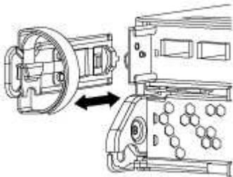
4. Drücken Sie die Verriegelung am Nockengriff, bis sie loslässt, öffnen Sie den Nockengriff vollständig, um das Controller-Modul aus der Mittelplatte zu lösen, und ziehen Sie das Controller-Modul anschließend mit zwei Händen aus dem Gehäuse heraus.
