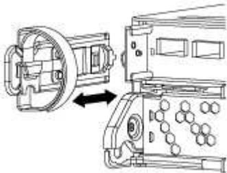
3. Drücken Sie die Verriegelung am Nockengriff, bis sie loslässt, öffnen Sie den Nockengriff vollständig, um das Controller-Modul aus der Mittelplatine zu lösen, und ziehen Sie das Controller-Modul anschließend mit zwei Händen aus dem Gehäuse heraus.
