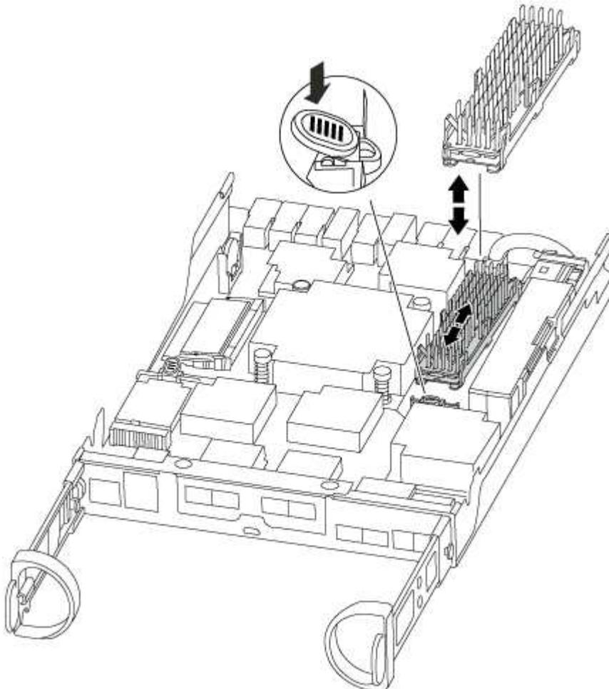
2. Ziehen Sie das Zwischenmodul vorsichtig gerade aus dem Gehäuse heraus.
