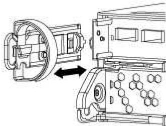
4. Drücken Sie die Verriegelung am Nockengriff, bis sie loslässt, öffnen Sie den Nockengriff vollständig, um das Controller-Modul aus der Mittelplatine zu lösen, und ziehen Sie das Controller-Modul anschließend mit zwei Händen aus dem Gehäuse heraus.
