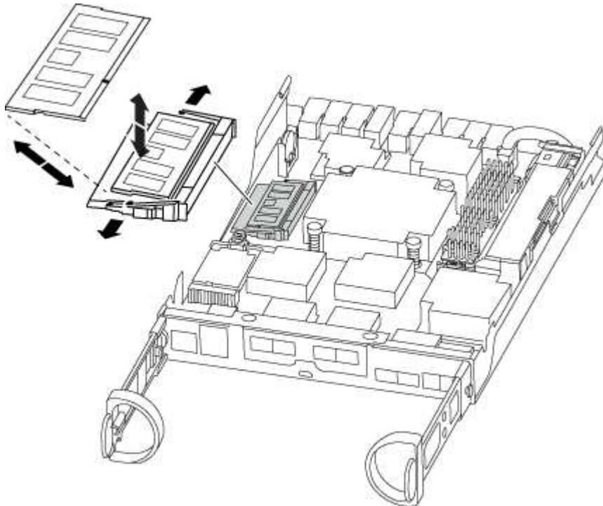
4. Wiederholen Sie diese Schritte, um bei Bedarf weitere DIMMs zu entfernen.
