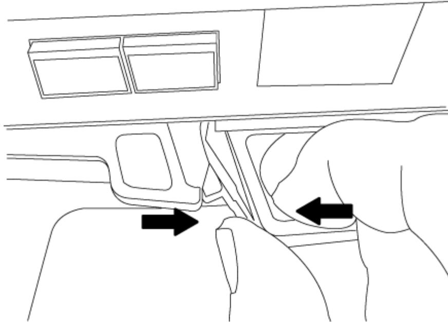
5. Stellen Sie das Controller-Modul an einer sicheren Stelle beiseite, und wiederholen Sie diese Schritte, wenn Sie ein weiteres Controller-Modul im Chassis haben.
