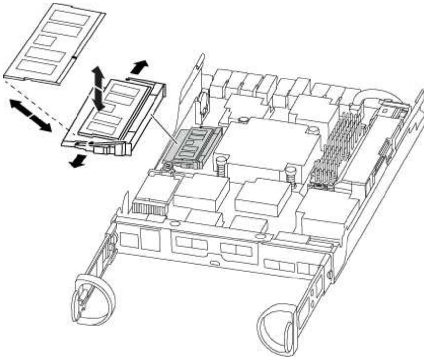
8. Entfernen Sie das Ersatz-DIMM aus dem antistatischen Versandbeutel, halten Sie das DIMM an den Ecken und richten Sie es am Steckplatz aus.
