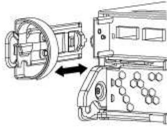
4. Wenn Sie nach dem Entfernen der Kabel die SFP-Module im System belassen, verschieben Sie sie in das neue Controller-Modul.
