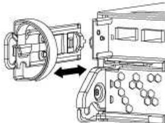
4. Drücken Sie die Verriegelung am Nockengriff, bis sie loslässt, öffnen Sie den Nockengriff vollständig, um das Controller-Modul aus der Mittelplatine zu lösen, und ziehen Sie das Controller-Modul anschließend mit zwei Händen aus dem Gehäuse heraus.
