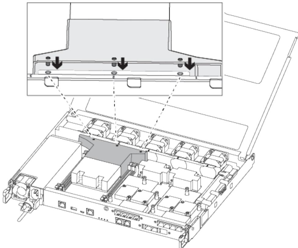
g. Schließen Sie die Abdeckung des Controller-Moduls, und ziehen Sie die Daumenschraube fest.
