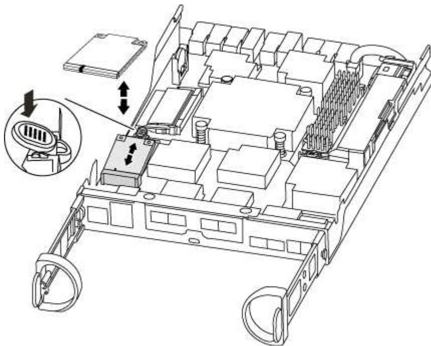
3. Drücken Sie die blaue Taste am Startmediengehäuse, um die Startmedien aus dem Gehäuse zu lösen, und ziehen Sie sie vorsichtig gerade aus der Buchse des Boot-Mediums heraus.
