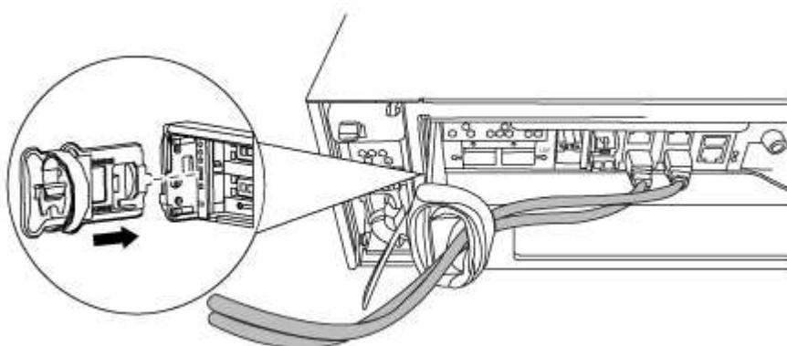
3. Lösen Sie die Daumenschraube am Nockengriff am Controller-Modul.
