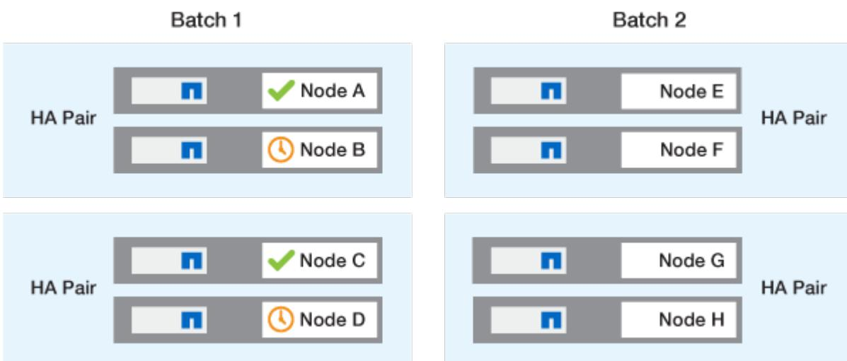
Der Prozess wird anschließend für die Nodes in Batch 2 wiederholt. Der erste Node jedes HA-Paars wird gleichzeitig mit dem ersten Node aller anderen HA-Paare im Batch aktualisiert.
