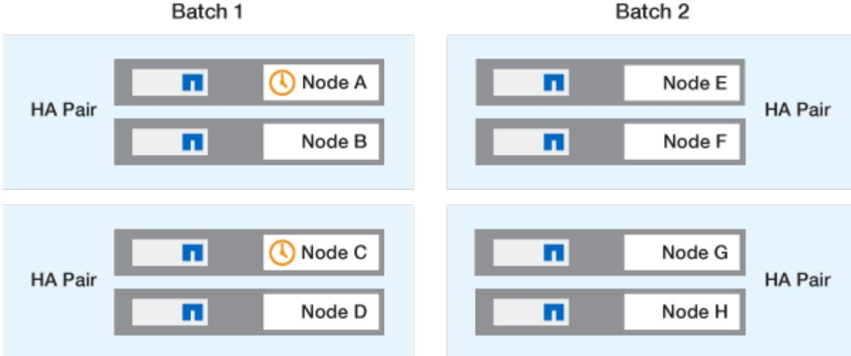
Nachdem das Upgrade der ersten Nodes jedes HA-Paars abgeschlossen ist, werden die Partner-Nodes in Batch 1 gleichzeitig aktualisiert.
