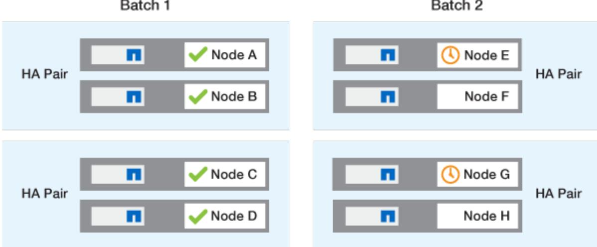
Nachdem das Upgrade der ersten Nodes jedes HA-Paars abgeschlossen ist, werden die Partner-Nodes in Batch 2 gleichzeitig aktualisiert.
