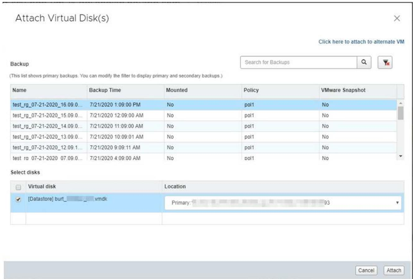
3. Wählen Sie im Fenster **Virtuelles Laufwerk anhängen** im Abschnitt **Sicherung** ein Backup aus.
