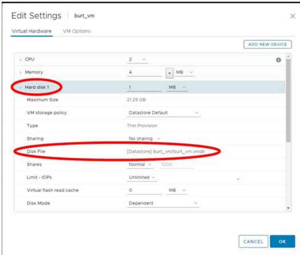
Auf der Seite „Einstellungen bearbeiten“ werden die Festplatten auf der VM aufgeführt. Sie können die Details für jede Festplatte erweitern, um die Liste der verbundenen virtuellen Laufwerke anzuzeigen.
