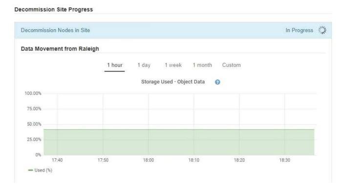
3. Überwachen Sie im Abschnitt Status des Knotens der Seite den Fortschritt des Stillstandsvorgangs, wenn Nodes entfernt werden.
