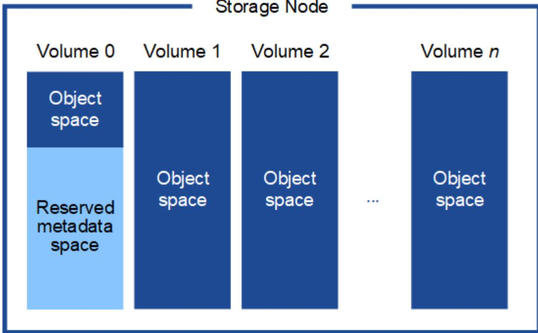
Um Redundanz zu gewährleisten und Objekt-Metadaten vor Verlust zu schützen, speichert StorageGRID drei Kopien der Metadaten für alle Objekte im System an jedem Standort. Die drei Kopien der Objektmetadaten werden gleichmäßig auf alle Storage-Nodes an jedem Standort verteilt.
