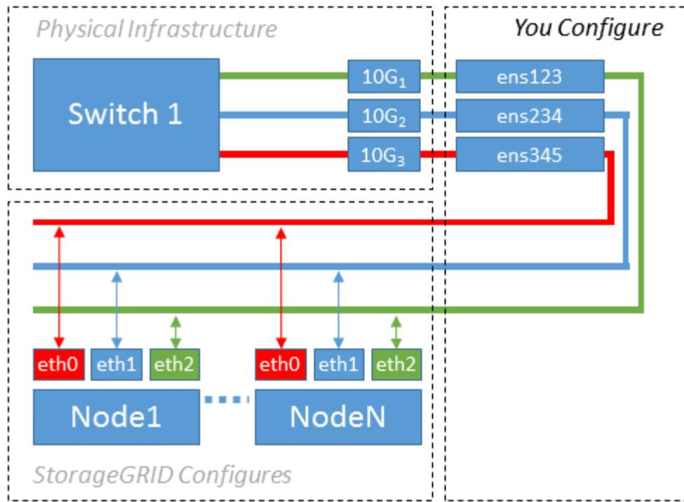
Das Betriebssystem Linux erstellt den `ensXYZ` Schnittstellen während der Installation oder beim Booten oder beim Hot-Added-Schnittstellen bereitgestellt. Es ist keine andere Konfiguration erforderlich als sicherzustellen, dass die Schnittstellen nach dem Booten automatisch eingerichtet werden. Sie müssen herausfinden, welche `ensXYZ` entspricht dem StorageGRID-Netzwerk (Grid, Administrator oder Client), sodass Sie später im Konfigurationsprozess die korrekten Zuordnungen bereitstellen können.
