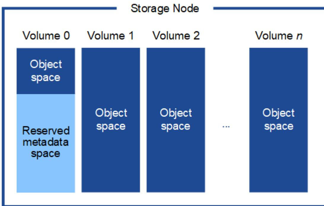
Um Redundanz zu gewährleisten und Objekt-Metadaten vor Verlust zu schützen, speichert StorageGRID drei Kopien der Metadaten für alle Objekte im System an jedem Standort. Die drei Kopien der Objektmetadaten werden gleichmäßig auf alle Storage-Nodes an jedem Standort verteilt.
