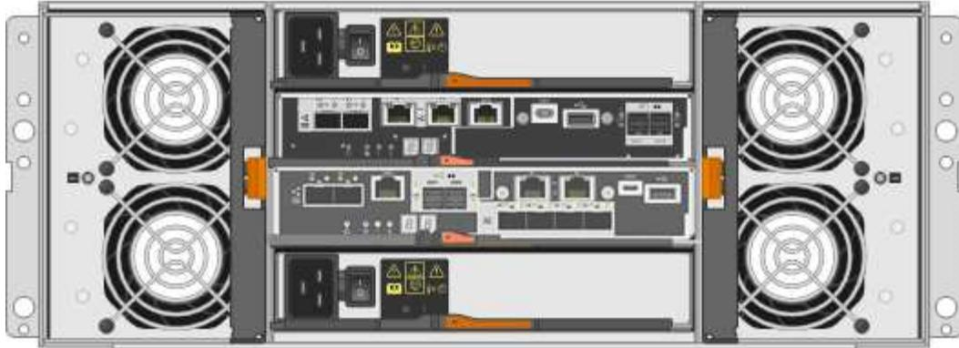
Die SG5760 verfügt über zwei Controller, zwei Lüfterbehälter und zwei Strombehälter.
