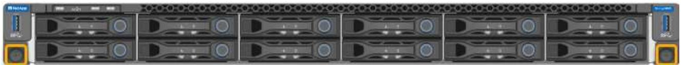
5. Schieben Sie den SG6000-CN-Controller nach vorn aus dem Rack, bis die Befestigungsschienen vollständig ausgefahren sind, und hören Sie, dass die Verriegelungen auf beiden Seiten einrasten.
