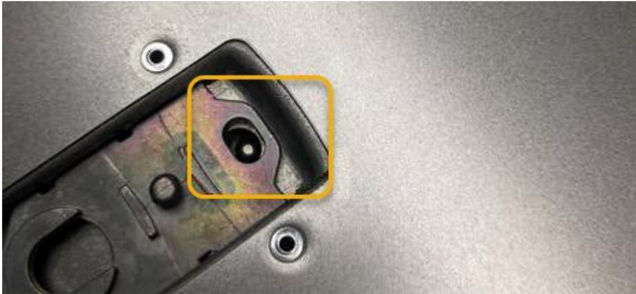
2. Drehen Sie die Verriegelung nach vorne und unten, bis sie anhält und die Abdeckung vollständig im Gehäuse sitzt. Stellen Sie sicher, dass an der Vorderkante der Abdeckung keine Lücken vorhanden sind.
