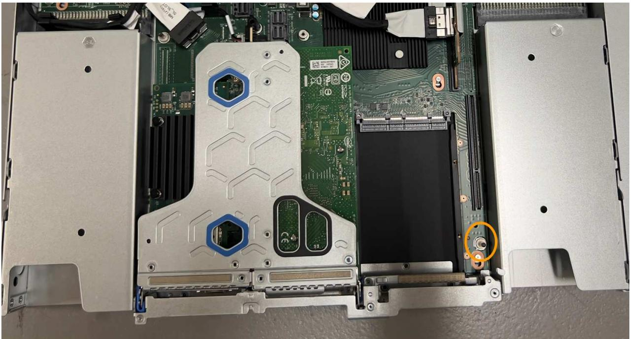
e. Positionieren Sie die Steckplatzbaugruppe im Gehäuse, und achten Sie darauf, dass sie mit dem Anschluss auf der Systemplatine und dem Führungsstift ausgerichtet ist.
