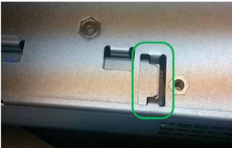
◦ **Falsch** — der Metallflansch der Batterie ist nicht in den Steckplatz an der Steuerung eingefügt:
