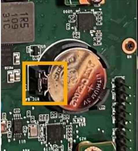
7. Entfernen Sie die Batterie, und entsorgen Sie sie ordnungsgemäß.
