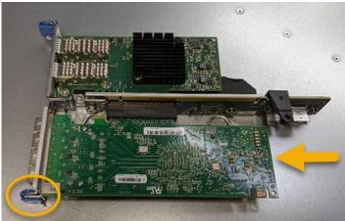
In der Riserbaugruppe befinden sich zwei Adapter: Ein Fibre-Channel-HBA und ein Ethernet-Netzwerkadapter. Der Fibre Channel HBA wird in der Abbildung angezeigt.
