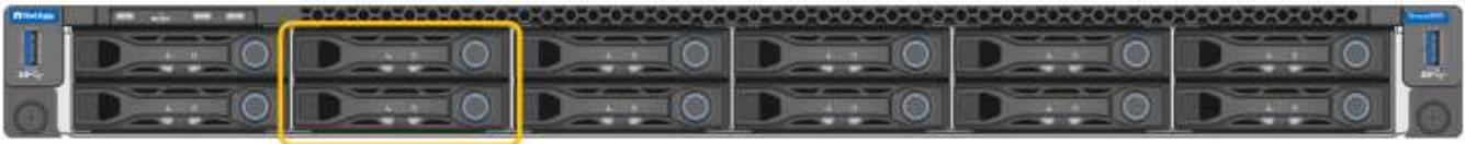
Die beiden durch die orangefarbene Umrandung gekennzeichneten Solid State-Laufwerke (SSDs) werden zur Speicherung des StorageGRID-Betriebssystems verwendet und aus Redundanzgründen mit RAID 1 gespiegelt. Wenn die SG100- oder SG1000-Services-Appliance als Admin-Node konfiguriert ist, werden diese Laufwerke zum Speichern von Audit-Protokollen, Kennzahlen und Datenbanktabellen verwendet.
