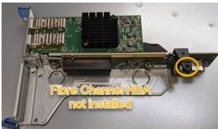
5. Positionieren Sie die Riserbaugruppe im Gehäuse, und stellen Sie sicher, dass sie am Anschluss und Führungsstift auf der Systemplatine ausgerichtet ist. Setzen Sie dann die Riserbaugruppe ein.
