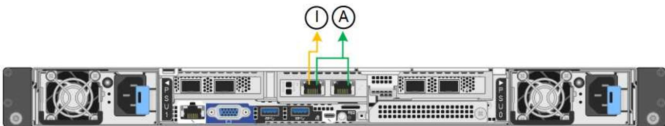
Im Independent-Modus ist nur der Management-Port links mit dem Admin-Netzwerk verbunden. Dieser Modus stellt keinen redundanten Pfad bereit. Der Management-Port auf der rechten Seite ist nicht verbunden und steht für temporäre lokale Verbindungen zur Verfügung (verwendet IP-Adresse 169.254.0.1).
