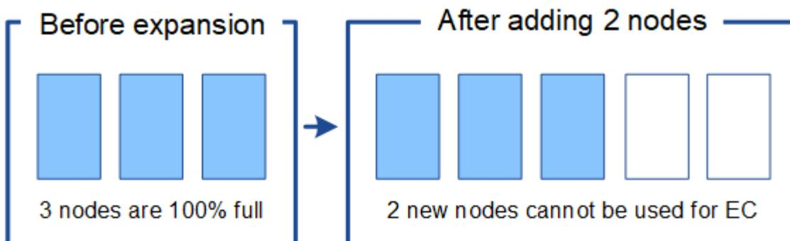
Um die neuen Storage-Nodes zu verwenden, sollten Sie das EC-Neuaustrich-Verfahren ausführen. Wenn dieses Verfahren ausgeführt wird, verteilt StorageGRID vorhandene Daten und Paritätsfragmente über alle Storage Nodes am Standort. In diesem Beispiel sind alle fünf Nodes nach Abschluss des EC-Ausgleichs nur zu 60 % voll, und Objekte können weiterhin auf allen Storage Nodes in das Erasure Coding-Schema 2+1 aufgenommen werden.
