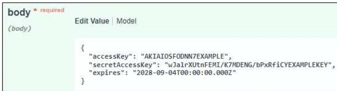
6. Wenn der Schlüssel abläuft, ersetzen Sie den Beispieleintrag für **expires** durch das Ablaufdatum und die Zeit als String im ISO 8601-Datenzeitformat (z. B. 2024-02-28T22:46:33-08:00). Wenn der Schlüssel nicht abläuft, geben Sie **null** als Wert für den Eintrag **expires** ein (oder entfernen Sie die Zeile **expires** und das vorangegangene Komma).
