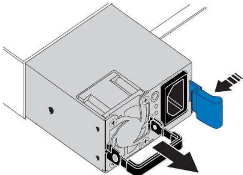
5. Schieben Sie das Ersatznetzteil mit der blauen Verriegelung nach rechts in das Gehäuse.
