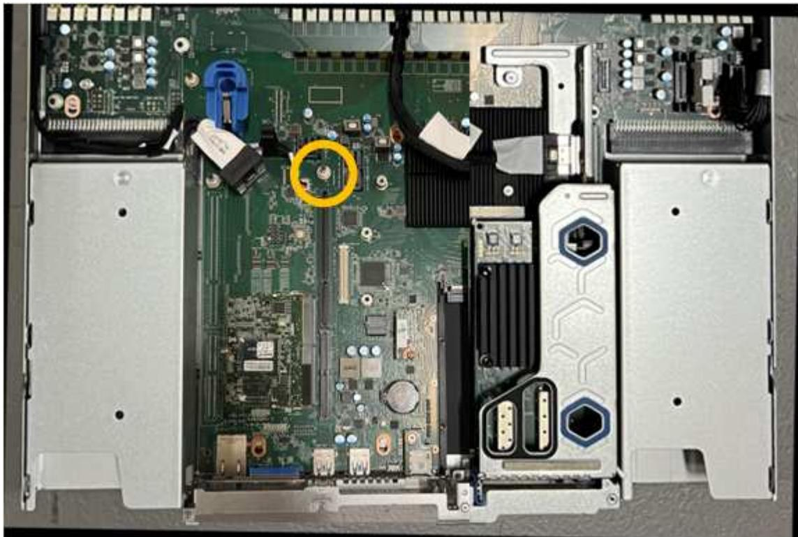
6. Positionieren Sie die Riser-Baugruppe im Gehäuse, und achten Sie darauf, dass sie mit dem Anschluss auf der Systemplatine und dem Führungsstift ausgerichtet ist.
