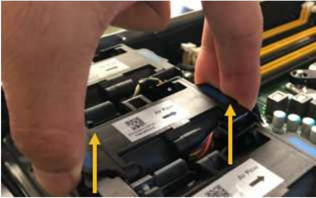
2. Schieben Sie den Ersatzlüfter in den offenen Steckplatz des Gehäuses.
