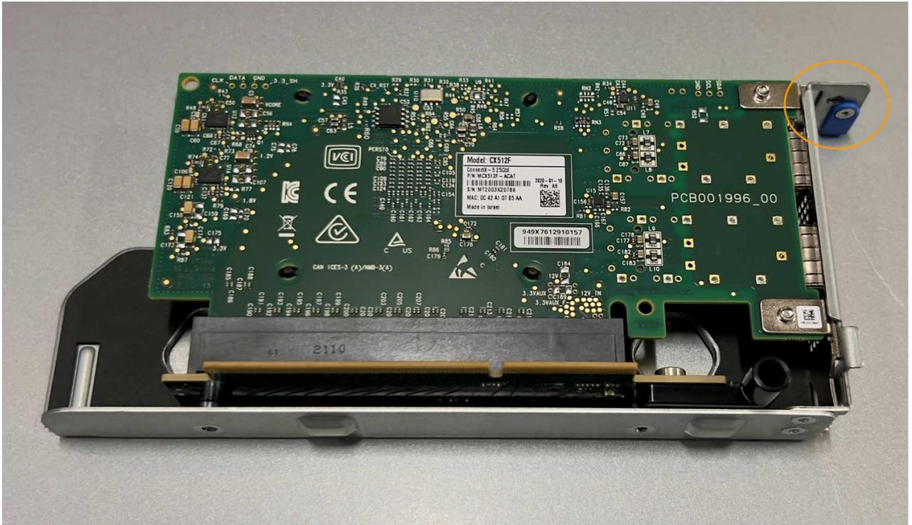
5. Öffnen Sie die blaue Verriegelung (eingekreist) auf der zu ersetzenden NIC, und entfernen Sie die NIC vorsichtig aus der Riserbaugruppe. Führen Sie die NIC leicht durch, um die NIC aus ihrem Anschluss zu entfernen. Verwenden Sie keine übermäßige Kraft.
