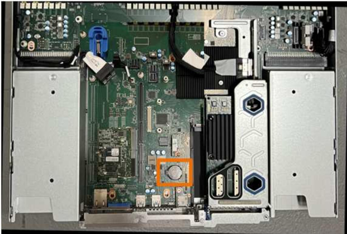
6. Drücken Sie den Halteclip (hervorgehoben) mit dem Finger oder einem Hebelwerkzeug aus Kunststoff von der Batterie weg, um ihn aus der Steckdose zu ziehen.
