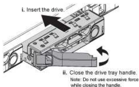
6. Setzen Sie das Ersatzlaufwerk in den Steckplatz ein, und schließen Sie dann den Laufwerkgriff.
