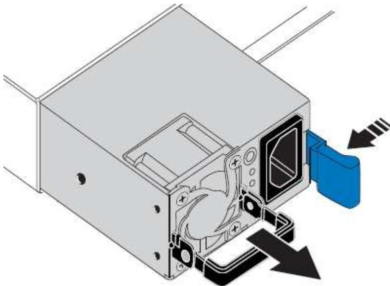
5. Schieben Sie das Ersatznetzteil mit der blauen Verriegelung nach rechts in das Gehäuse.
