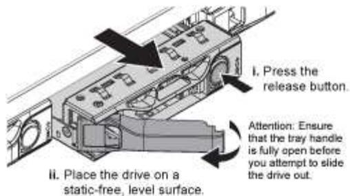
Der Griff an den Antriebsfedern öffnet sich teilweise, und das Laufwerk löst sich aus dem Schlitz.
