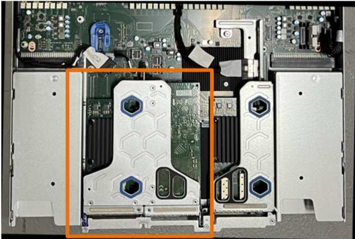
3. Fassen Sie die Riserbaugruppe durch die blau markierten Löcher und heben Sie sie vorsichtig nach oben. Bewegen Sie die Riser-Baugruppe beim Anheben in Richtung Gehäusevorderseite, damit die externen Anschlüsse in den installierten NICs das Gehäuse entfernen können.
