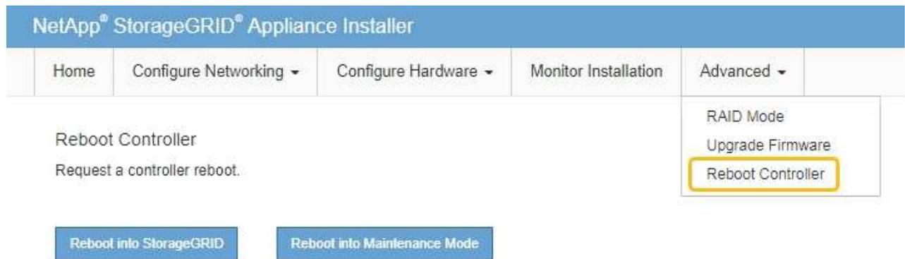
Die Appliance kann bis zu 20 Minuten dauern, bis sie neu gestartet und wieder in das Grid eingesetzt wird. Um zu überprüfen, ob das Neubooten abgeschlossen ist und dass der Node wieder dem Grid beigetreten ist, gehen Sie zurück zum Grid Manager. Auf der Seite **NODES** sollte ein normaler Status (grünes Häkchen-Symbol) angezeigt werden (✓ Links neben dem Node-Namen) für den Appliance-Node. Dies bedeutet, dass keine Warnmeldungen aktiv sind und der Node mit dem Grid verbunden ist.
