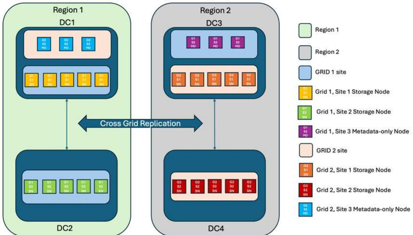
Diese Lösung mit vier separaten Standorten bietet vollständige Redundanz von zwei separaten StorageGRID-Systemen mit einem RPO von 0 und nutzt sowohl synchrone Replizierung an mehreren Standorten als auch asynchrone Replizierung in mehreren Grids. Bei jedem einzelnen Standort kann der Client-Betrieb auf beiden StorageGRID Systemen unterbrechungsfrei ausgeführt werden.
