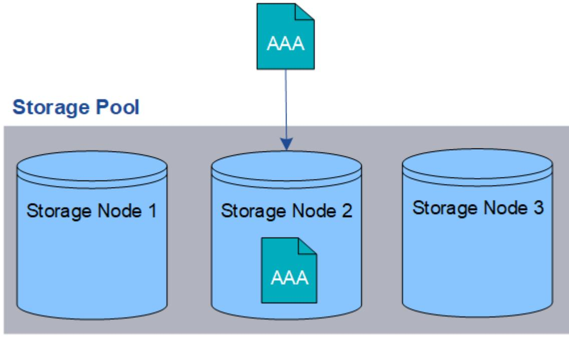
Wenn eine ILM-Regel nur eine replizierte Kopie eines Objekts erstellt, ist der Zugriff auf das Objekt möglich, wenn der Storage-Node nicht verfügbar ist. In diesem Beispiel verlieren Sie vorübergehend den Zugriff auf das Objekt AAA, wenn Storage Node 2 offline ist, z. B. während eines Upgrades oder eines anderen Wartungsverfahrens. Sie verlieren das Objekt AAA vollständig, wenn Storage Node 2 ausfällt.
