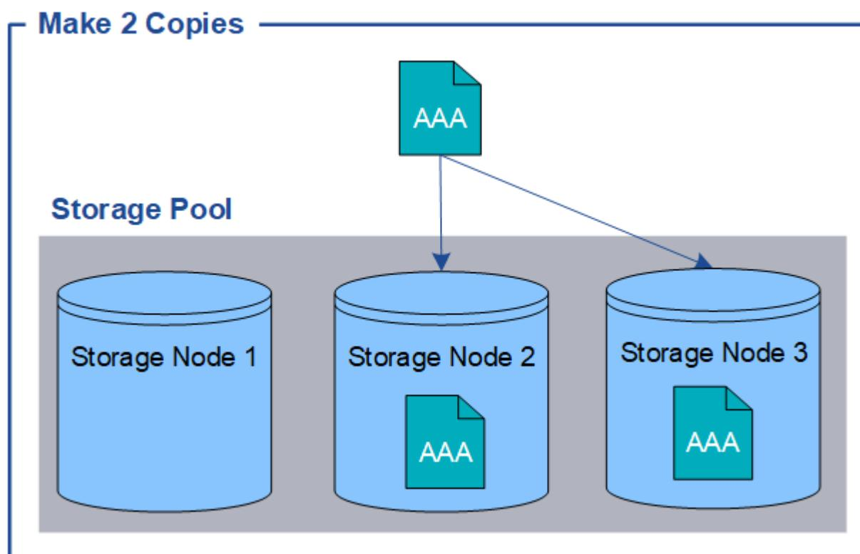
Wenn StorageGRID Objekte mit dieser Regel übereinstimmt, werden zwei Kopien des Objekts erstellt, wobei jede Kopie auf einem anderen Storage-Node im Storage-Pool platziert wird. Die beiden Kopien können auf zwei der drei verfügbaren Storage-Nodes platziert werden. In diesem Fall wurden in der Regel Objektkopien auf Speicherknoten 2 und 3 platziert. Da es zwei Kopien gibt, kann das Objekt abgerufen werden, wenn einer
