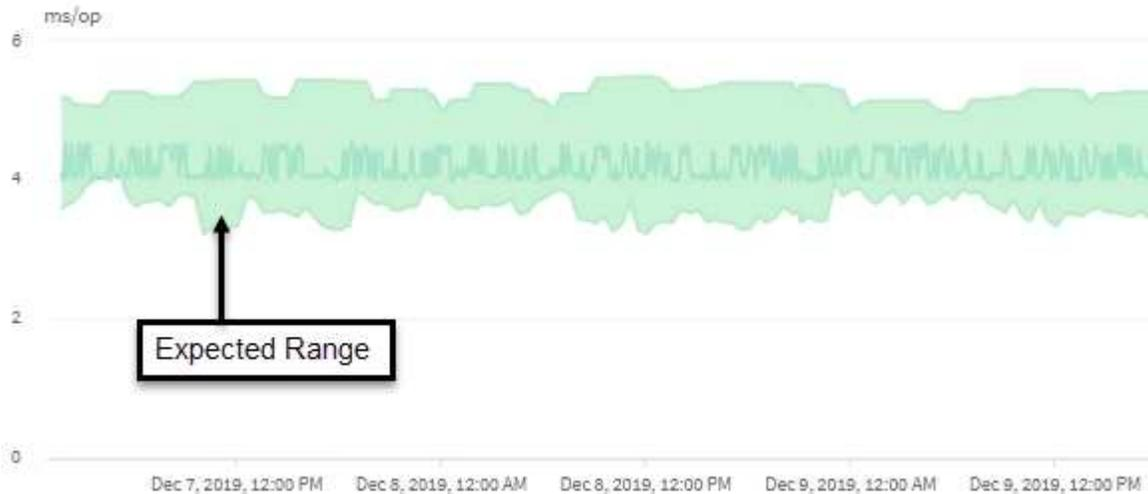
En este ejemplo, la latencia de un volumen tiene un pronóstico de latencia, en gris, de 3.5 milisegundos por operación (ms/op) a su nivel más bajo y de 5.5 ms/op a su nivel más alto. Si la latencia real, en azul, aumenta de repente a 10 ms/op, debido a un pico intermitente en el tráfico de la red o contención en un componente del clúster, supera la previsión de latencia y ha superado el umbral de rendimiento dinámico.
