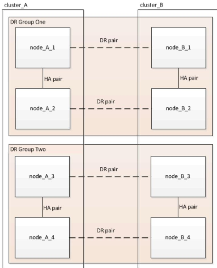
En la siguiente ilustración, se muestra la organización de los nodos en una configuración de MetroCluster de cuatro nodos:
