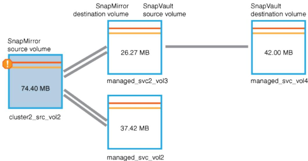
5. Coloque el cursor sobre el icono de error para ver el cuadro de diálogo emergente que muestra la configuración del umbral y ver que el volumen ha superado el umbral de error, lo que indica un problema de capacidad.
