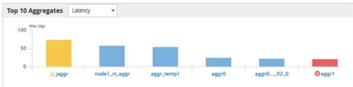
Para cada gráfico, el eje X muestra los ejecutantes superiores del tipo de objeto seleccionado. El eje Y muestra las unidades aplicables al contador seleccionado. Al hacer clic en el enlace del nombre del objeto debajo de cada elemento de gráfico de barras vertical, se desplaza hasta la página de inicio de rendimiento del objeto seleccionado.
