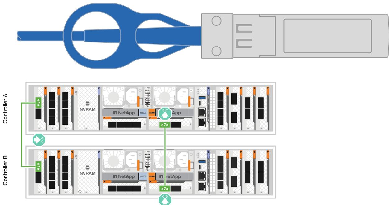
2. Conecte los puertos del módulo Ethernet a la red host.
