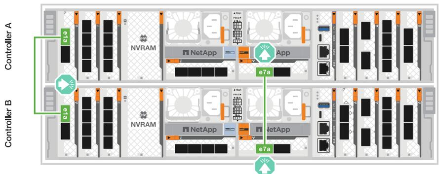
2. Conecte los puertos del módulo Ethernet a la red host.
