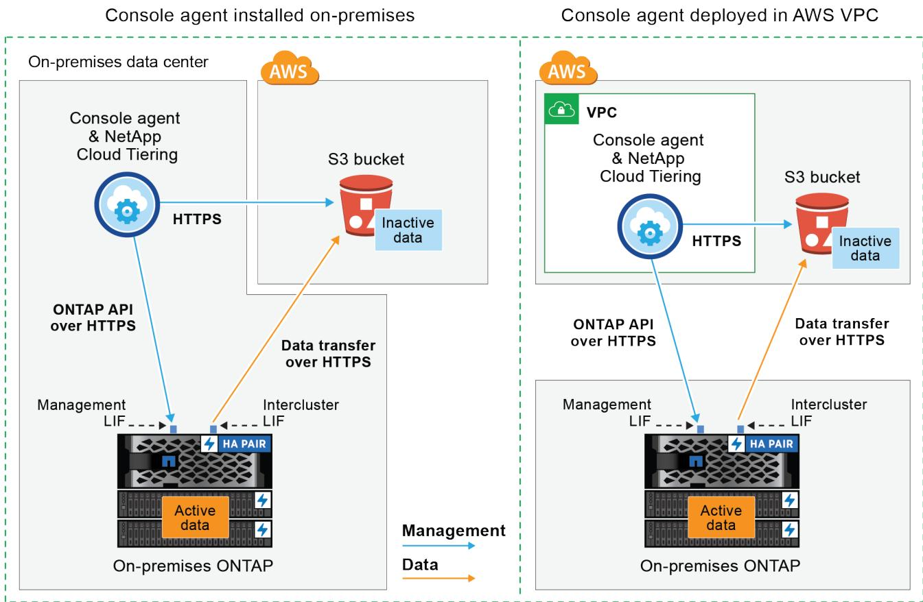
El siguiente diagrama muestra el método de **conexión privada** y las conexiones que debe preparar entre los componentes. Puede utilizar el agente de consola que haya instalado en sus instalaciones o un agente que haya implementado en AWS VPC.
