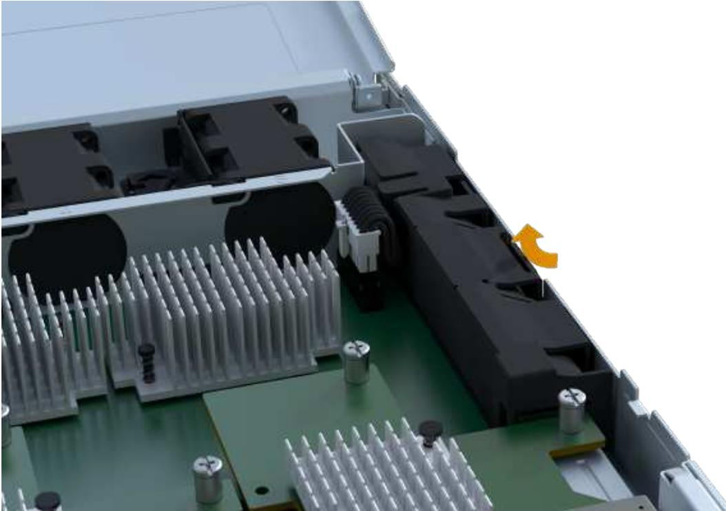
4. Apriete suavemente el conector que aloja el cableado de la batería. Tire hacia arriba, desconectando la batería de la placa.
