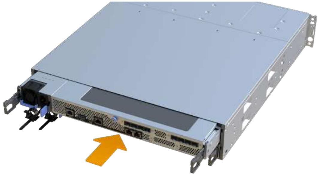
3. Instale los SFP desde la controladora original en los puertos de host de la nueva controladora, si se instalaron en la controladora original y vuelva a conectar todos los cables.
