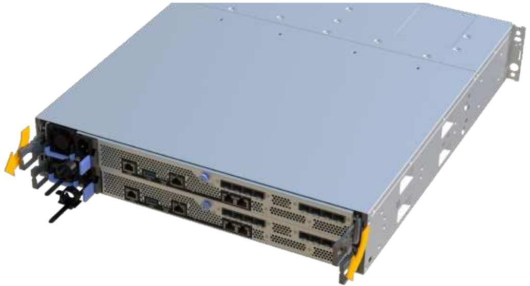
6. Con dos manos y las asas, deslice el compartimento de controladoras para sacarlo de la bandeja. Cuando la parte frontal del controlador esté libre del gabinete, utilice dos manos para extraerlo por completo.
