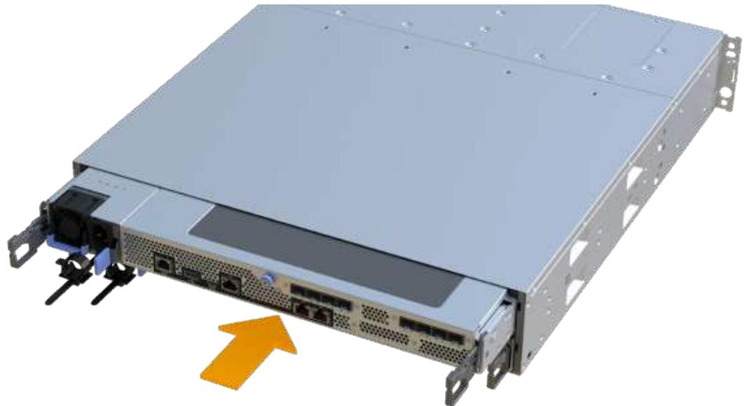
3. Si se lo ha quitado, instale SFP en la nueva HIC y vuelva a conectar todos los cables. Si está usando más de un protocolo de host, asegúrese de instalar los SFP en los puertos de host correctos.
