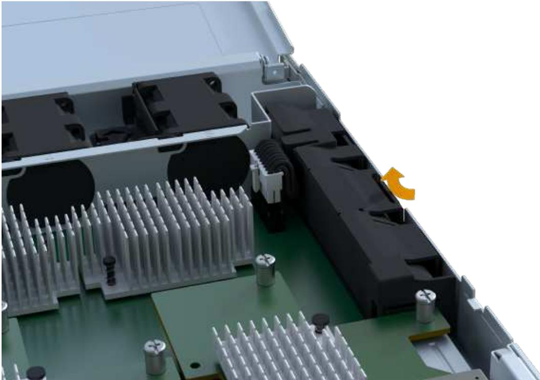
5. Apriete suavemente el conector que aloja el cableado de la batería. Tire hacia arriba y desconecte la batería de la placa.
