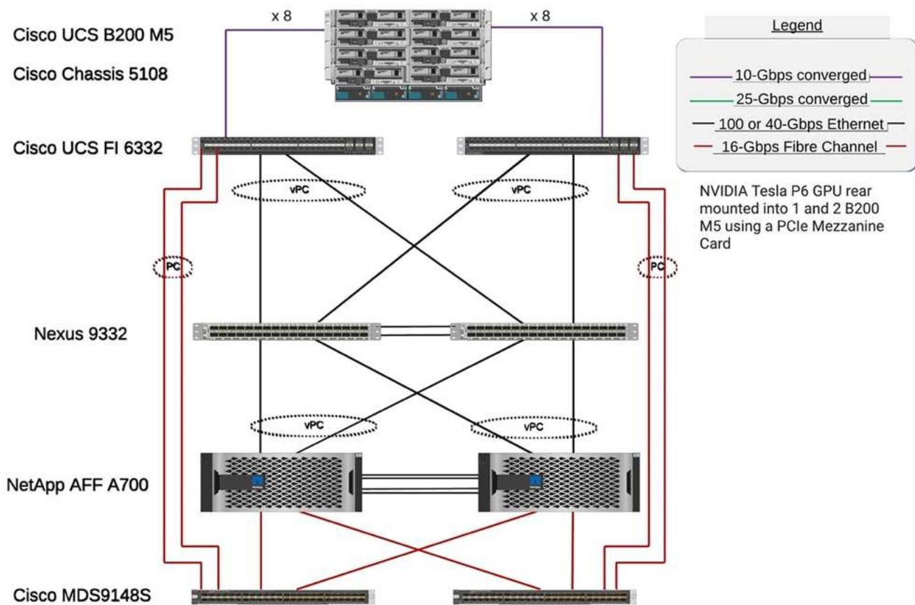
En el siguiente diagrama se describen los detalles del cableado FlexPod.
