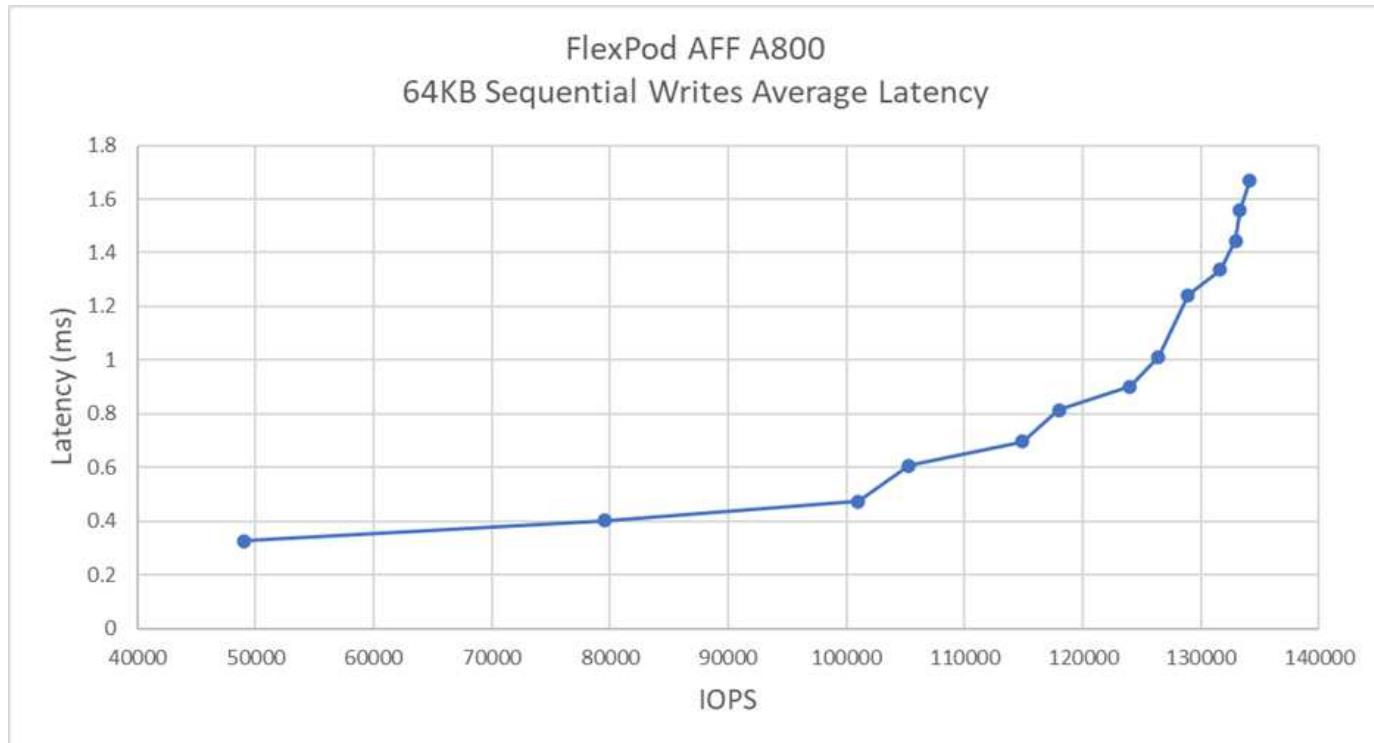
En nuestras pruebas, descubrimos que el sistema alcanzó alrededor de 120 000 IOPS, a la vez que mantiene una latencia por debajo de 1 ms en el lado del servidor.
