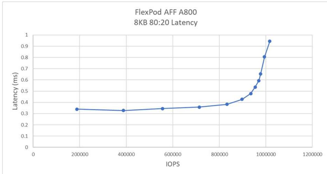
En nuestras pruebas, descubrimos que el sistema alcanzó más de 1 millón de IOPS, a la vez que mantiene solo menos de 1 ms de latencia en el lado del servidor.
