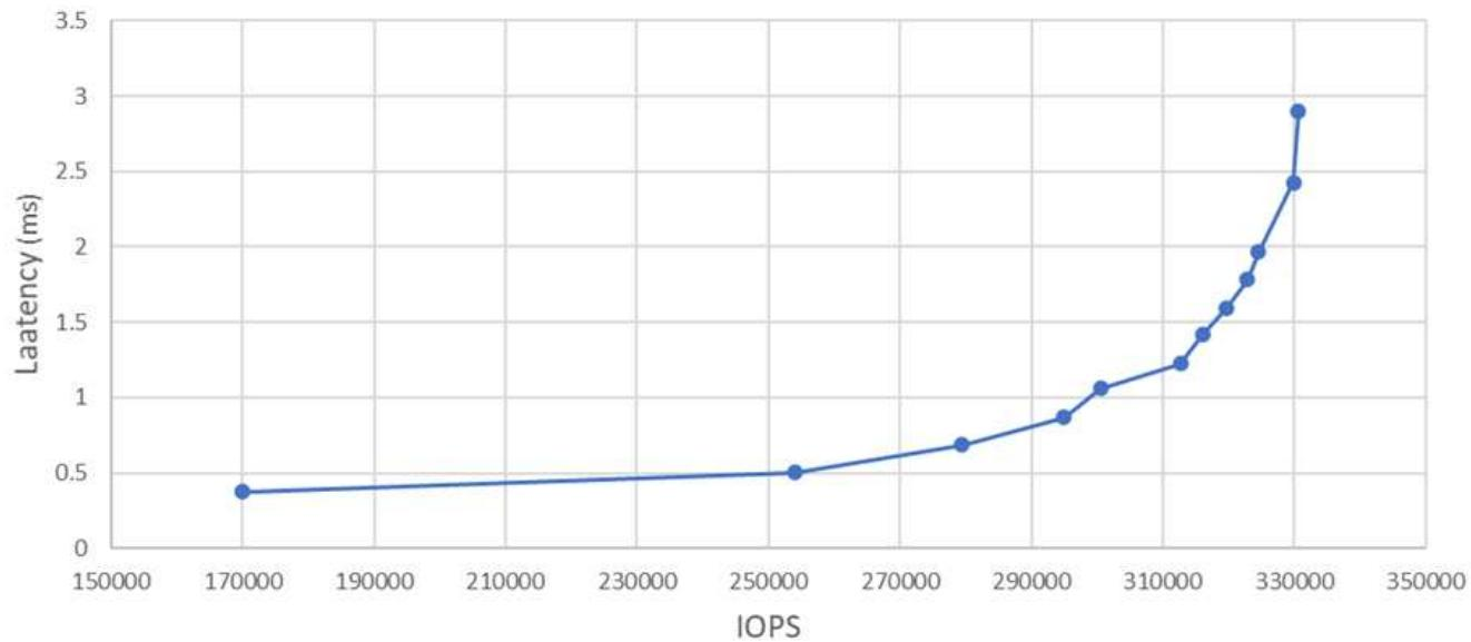
En nuestras pruebas, descubrimos que el sistema alcanzó cerca de 300 000 IOPS, a la vez que mantiene solo menos de 1 ms de latencia en el lado del servidor.
